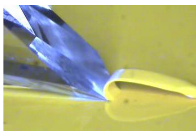
積層塗膜の分析用断面作製
